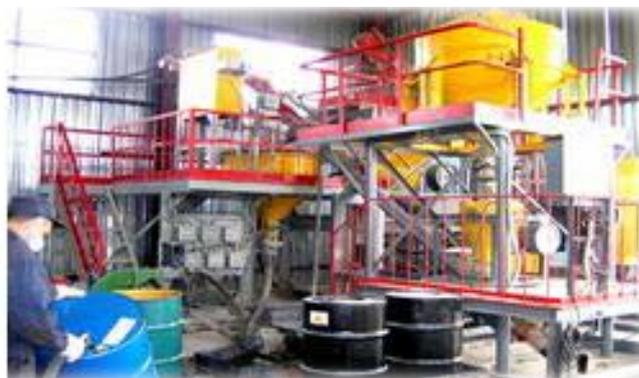
*Модульная установка цементирования радиоактивных отходов*
