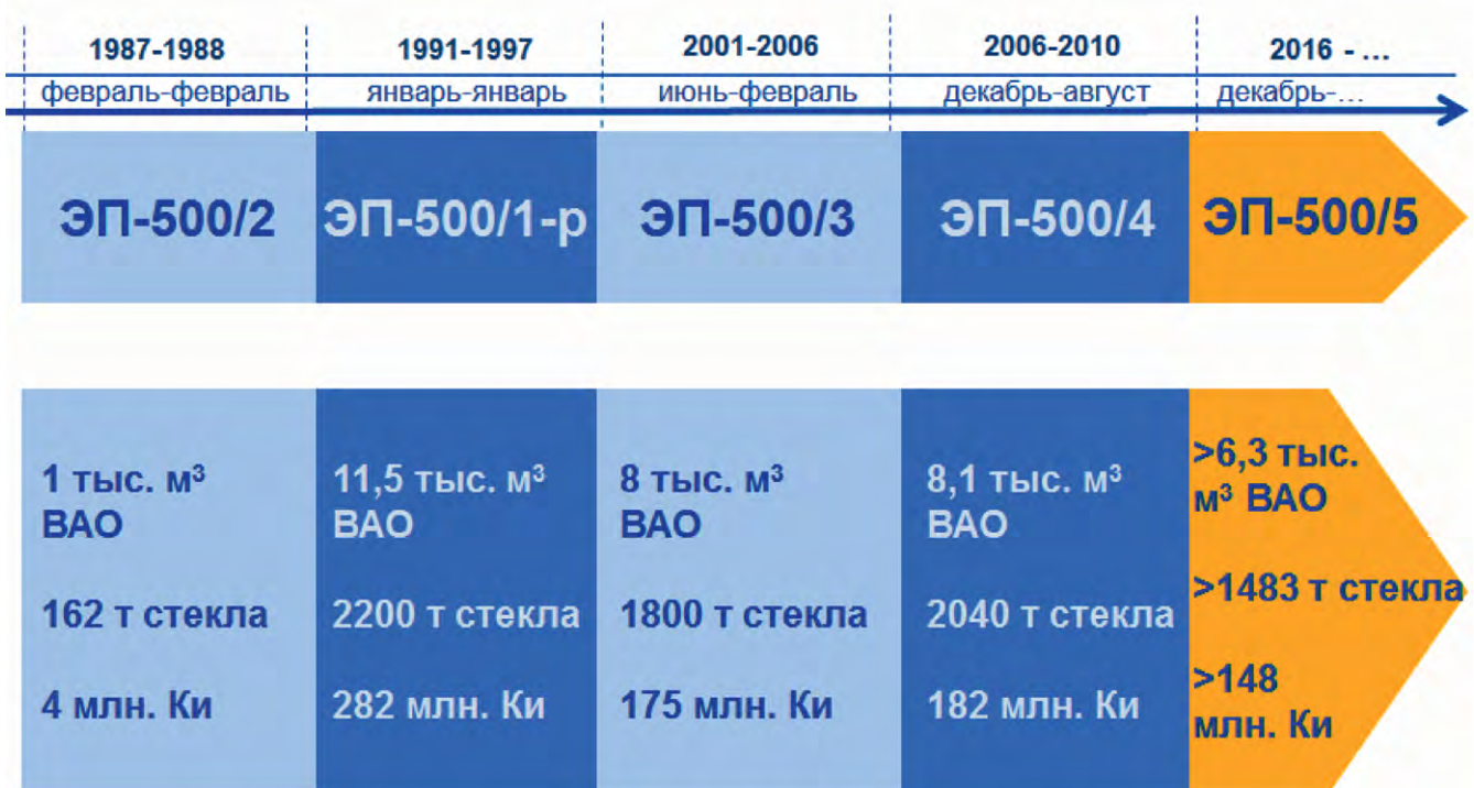
Рис. 1. Результаты эксплуатации печей остекловывания ВАО на ФГУП «ПО «Маяк»
