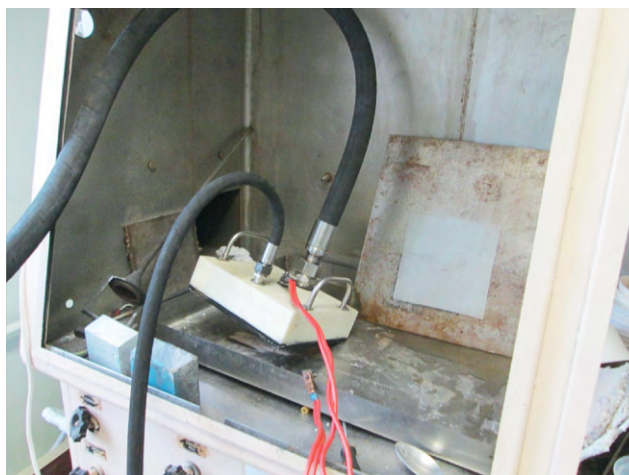
Рис.2. Инструмент – ячейка с рабочей площадью 4 дм 2 и подсоединёнными технологическими линиями. На заднем плане участок листа из углеродистой стали, обработанный этой ячейкой
