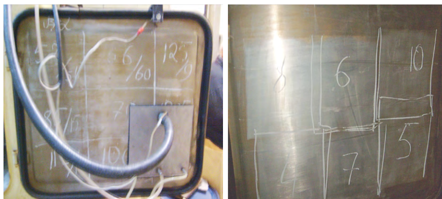
Рис. 3. Инструмент – ячейка площадью 2,9 дм 2 на двери перчаточного бокса (радиохимическая лаборатория ИФХАН) и участки двери, обработанные ячейкой
