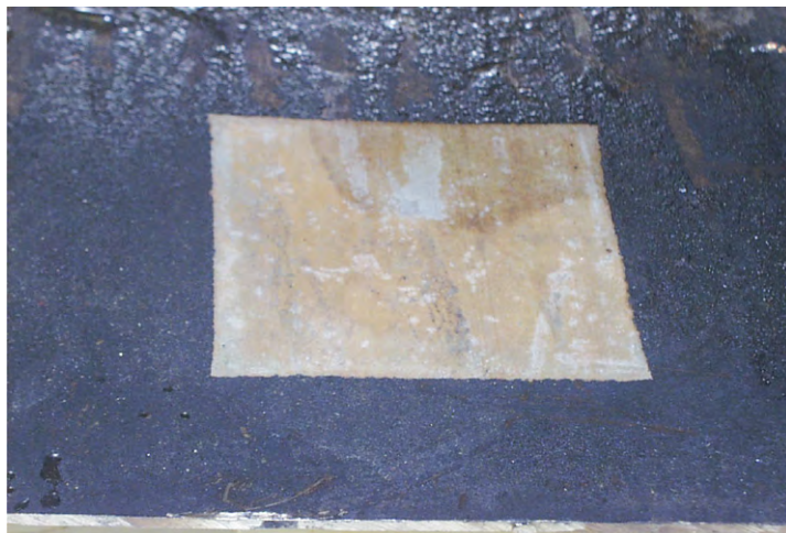
Рис. 4. Участок газохода установки сжигания РАО площадью 1 дм 2 , очищенный от сажи и радионуклидов за 1 цикл длительностью 15 мин. Материал газохода – нержавеющая сталь 12Х18Н10Т
