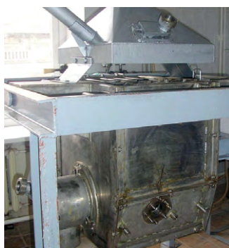
Рис. 3. Общий вид малогабаритного водоохлаждаемого кессонного плавителя и формирование расплава плазменной струей
