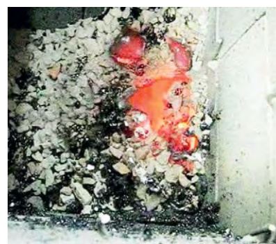
Рис. 3. Общий вид малогабаритного водоохлаждаемого кессонного плавителя и формирование расплава плазменной струей
