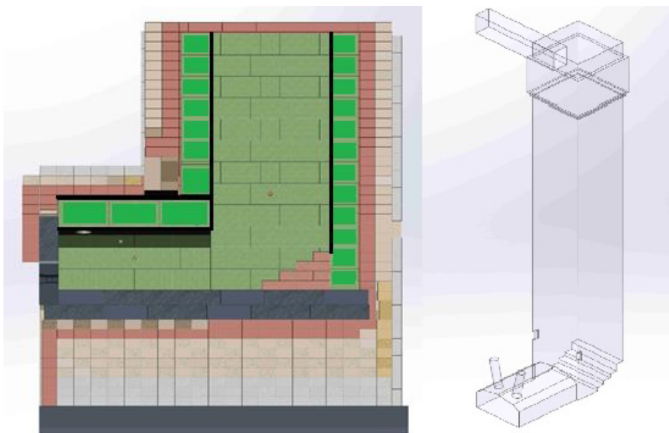
Рис. 1. Модель плавителя шахтной печи (продольный разрез) и модель внутреннего объема плавителя и шахты печи
