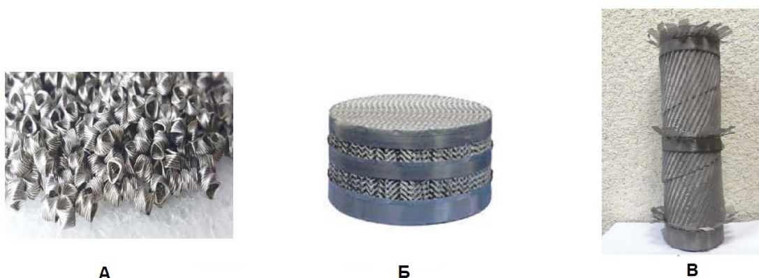
Рис. 2 – Некоторые виды насадок: А – нерегулярная спирально-призматическая насадка (СПН), Б – регулярная насадка Sulzer CY, В – регулярная рулонная ленточно-винтовая насадка (РЛВН)
