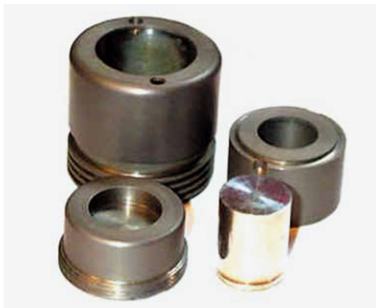
Капсулы с источниками, используемыми в ядерной медицине Source capsules used in medical teletherapy units
