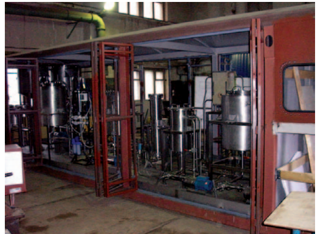
Рис. 4. Передвижной вариант очистной мембранной установки ОМУ-100
