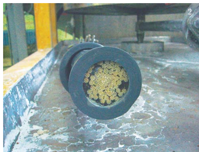
Рис. 1. Ультрафильтрационный модуль с одноканальными (1) и многоканальными (2) волокнами Fig. 1. Ultrafiltration modules with single-channel (1) and multi-channel (2) fibres
