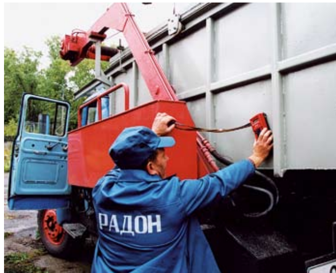
Контрольный замер мощности излучения по борту спецмашины Radiation control the vehicle
