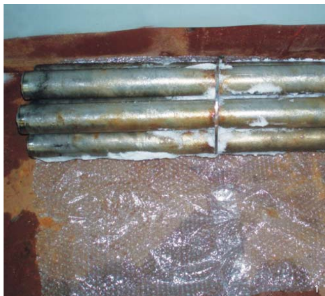
Рис. 2. Вид фрагментов чехлов до (1) и после (2) дезактивации Fig. 2. Basket fragments before (1) and after (2) decontamination
