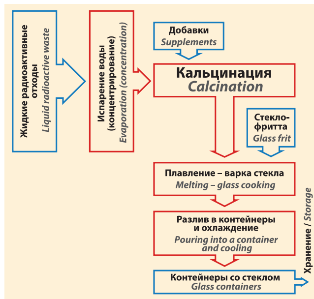
Схема остекловывания радиоактивных отходов (двухстадийный процесс) Diagrams of the radioactive waste vitrification processes (two-stage process)
