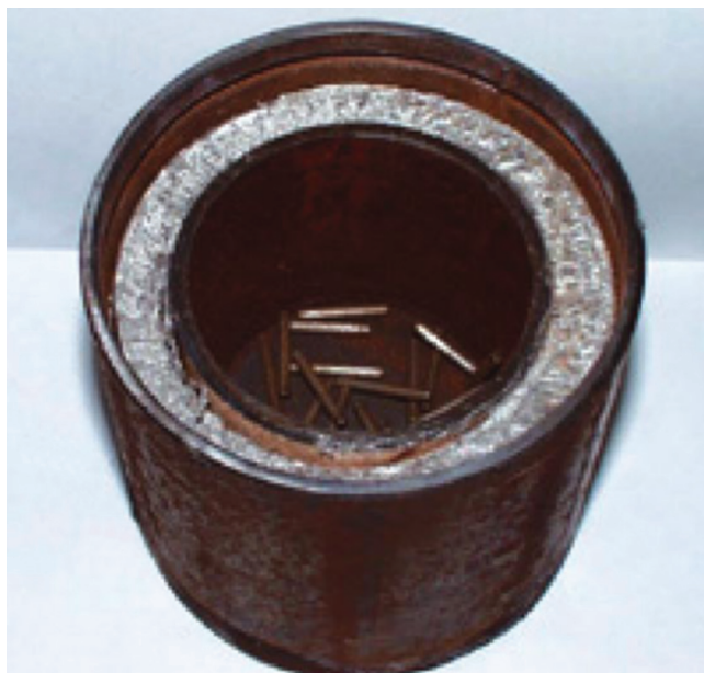
Герметичная металлическая капсула для ИИИ с долгоживущими \alpha -излучателями A sealed metallic capsule for SIRs that contain long-lived \alpha -emitters
